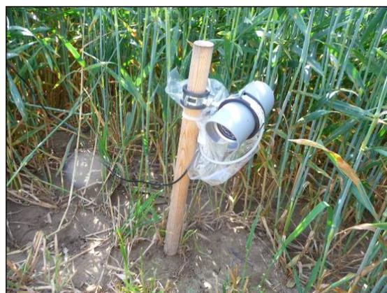
Abbildung 15: Technik zur Observierung mittels Infrarotkamera (Bild links: Datenrecorder und Autobatterie; Bild rechts: Infrarotkamera)
