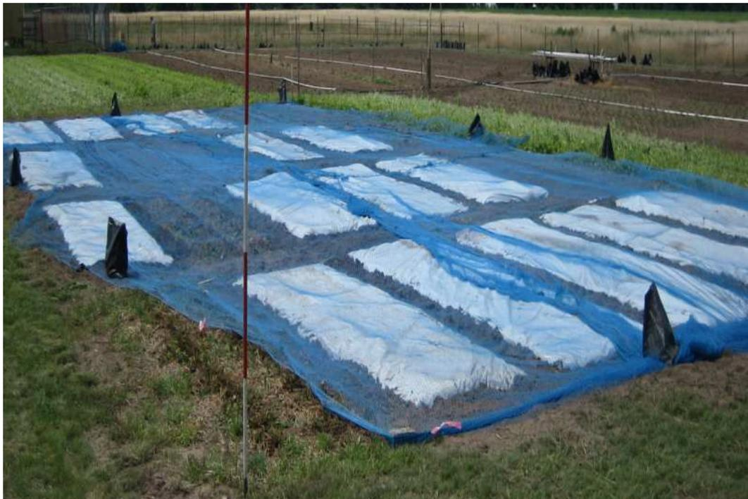
Abb. 4: Mit Silofolie abgedeckte sowie nicht abgedeckte Versuchspartellen. Alle Partellen wurden zusätzlich mit einem Vogelschutznetz geschützt.
