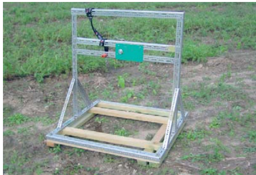
Abb. 33: Metallgestell als Geräteträger
