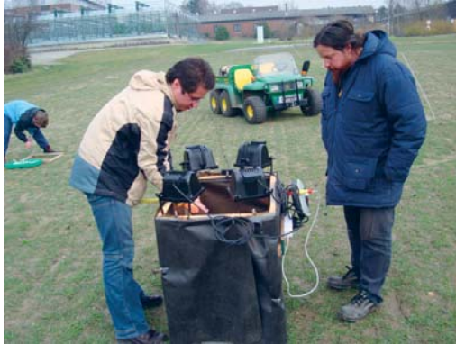
Abb. 36: Halterung mit künstlichem Licht und Schutz gegen Fremdlichteinfall
