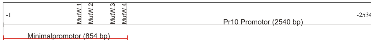
Abbildung 17: Schematische Darstellung der Promotorkonstrukte von PR10.1 . Es wurden Konstrukte voller Länge mit vier bzw. drei mutierten WRKY -Bindestellen, sowie der Minimalpromotor und der Minimalpromotor mit vier bzw. drei mutierten WRKY -Bindestellen hergestellt. Die Stelle MutW2 existiert nur für den Promotor von 'Regent' Allel B.
