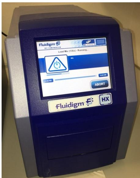
Abbildung 19: IFC Controller HX zur Vorbereitung des 96.96 Dynamic Array™ Chip
