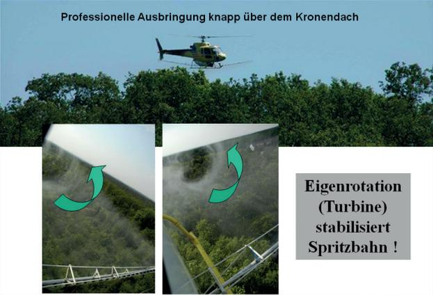
Eigenrotation (Turbine) stabilisiert Spritzbahn !
