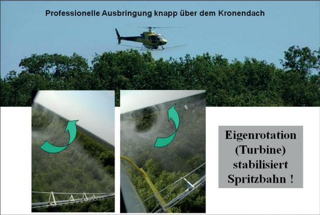
**Eigenrotation (Turbine) stabilisiert Spritzbahn !**
