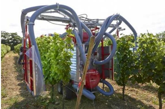
**Abb. 1** UV C-Prototyp für die Behandlung von Reben
