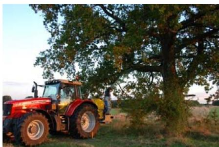
**Abb. 1** Einsatz der Sprühkanone am Einzelbaum im Stand
