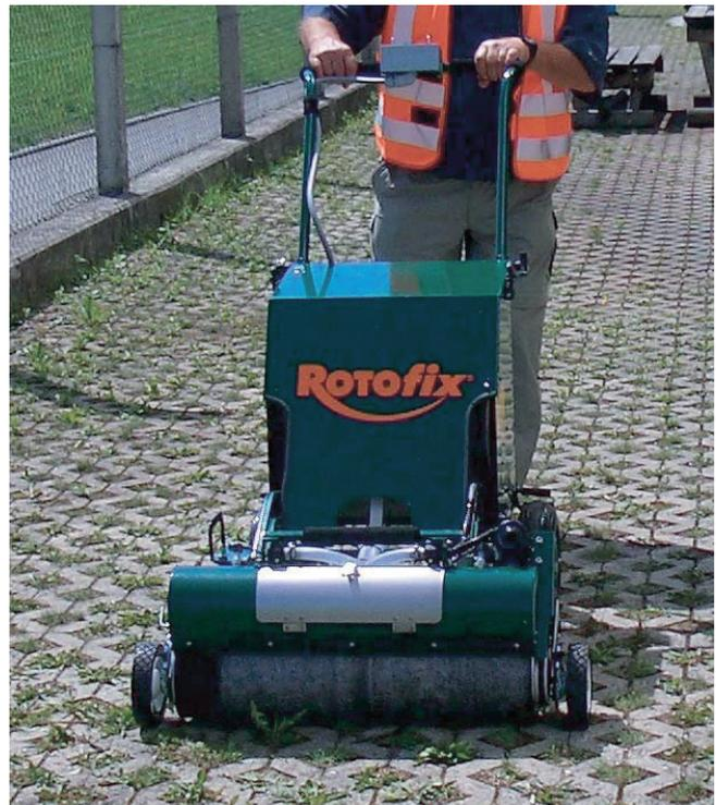
Abb. 10. Walzenstreichgerät Rotofix der Firma Rotowiper GmbH.
