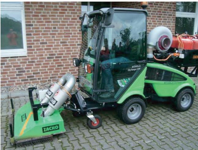
Abb. 3. Trägerfahrzeug City Ranger 2200 der Firma Nilfisk-Egholm (mit ZACHO Heißluft-System).
