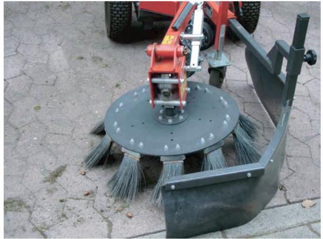
Abb. 2. Wildkrautbürste UB 500 der Firma Kersten Maschinen GmbH.
