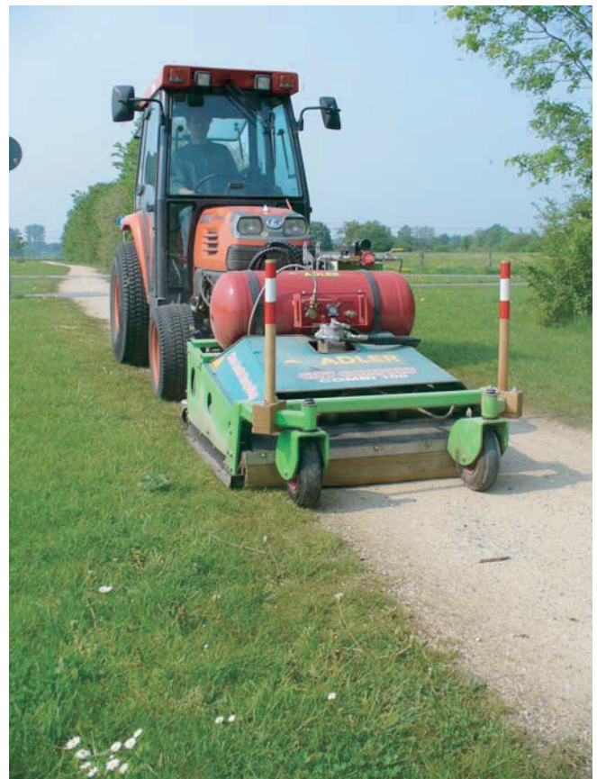
Abb. 2. Heißluft-Verfahren zur Unkrautbekämpfung.
