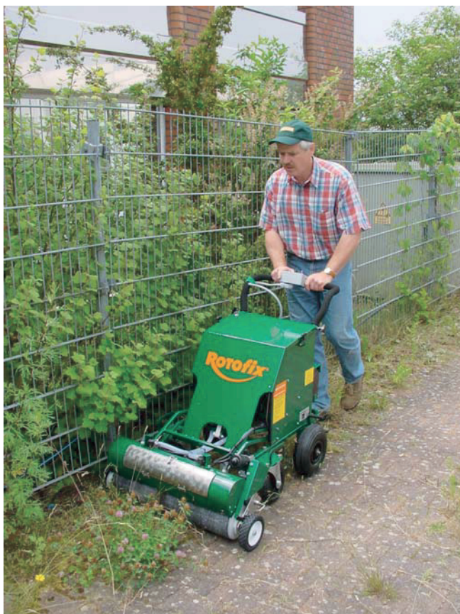
Abb. 1. Walzenstreichergerät Rotofix im Einsatz.
