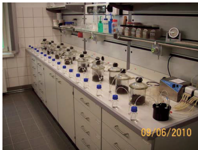
Abb. 1. Laborversuchsanlage mit Schlauchpumpe, Reaktionsgefäßen, Gas-Vials und NH 3 -Waschflaschen.
