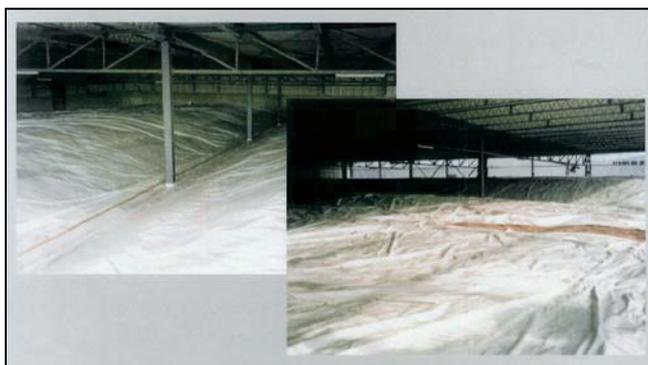
Abb. 5. Hermetische Abdichtung der Getreideoberfläche in Getreidelagern vor einer Begasung der Ware mit Kohlendioxid.
