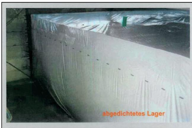
**Abb. 9.** Abgedichtetes, eingekoffertes Getreide in einer Holzbox, eine so genannte abgedichtete Getreidescheibe; die gasdichte Plastikfolie ist am Boden des Lagers gasdicht fixiert.
