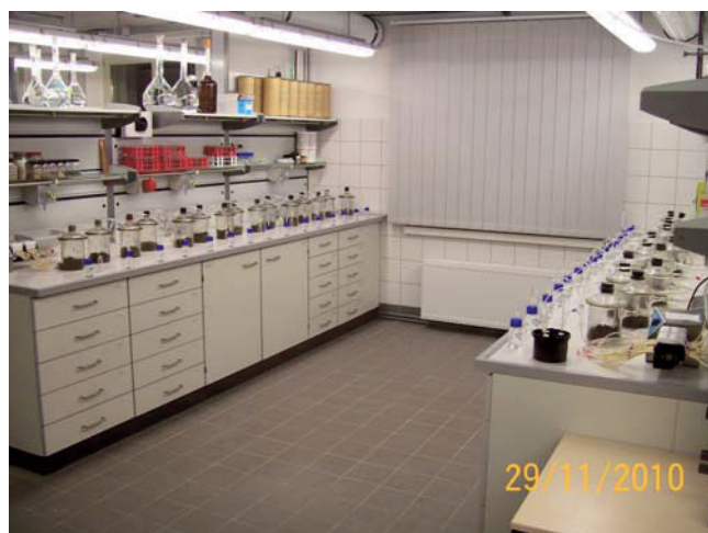
Abb. 1a. Versuchsanlage mit Schlauchpumpe, Reaktionsgefäßen, Vials und Waschflaschen. Experimental setup.
