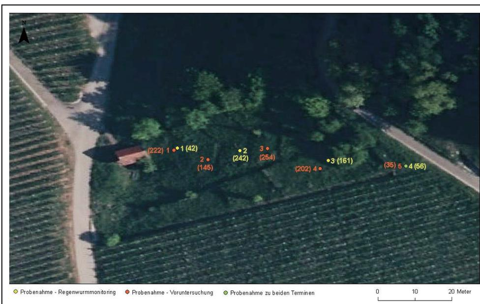
**Abb. 2.** GPS-gestützte Einmessung der Teilflächen für das Regenwurmmonitoring bei einer Referenz mit langer Bewirtschaftungshistorie und typischer heterogener Belastungsverteilung – analysierte Gesamtgehalte mg Cu/kg Boden TM (s. Flächencharakterisierung einer Beispielfläche), (Quelle: © BKG 2014, DOP40).
