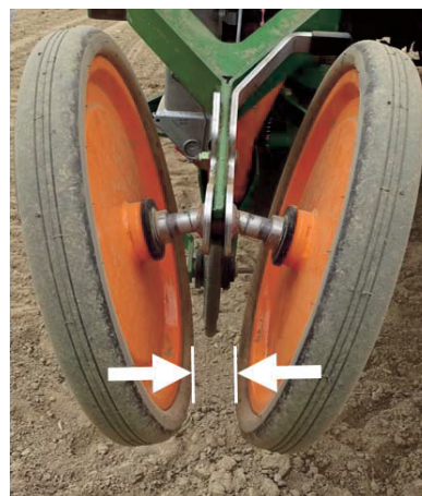
Abb. 5. Nachläufer 1 außen montiert.
