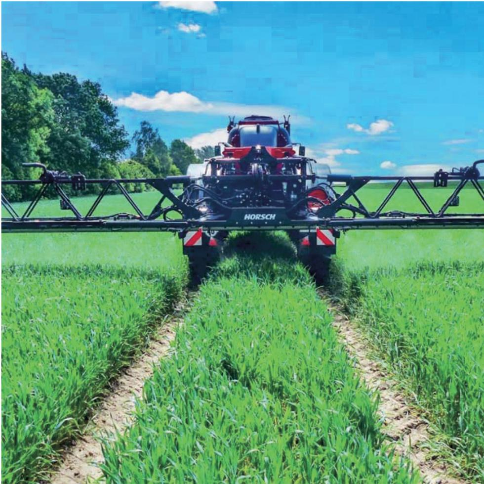
**Abb. 2.** Aussparung der Fahr-gasse bei der Applikation von Pflanzenschutzmitteln durch eine Fahrgassenabschaltung.
