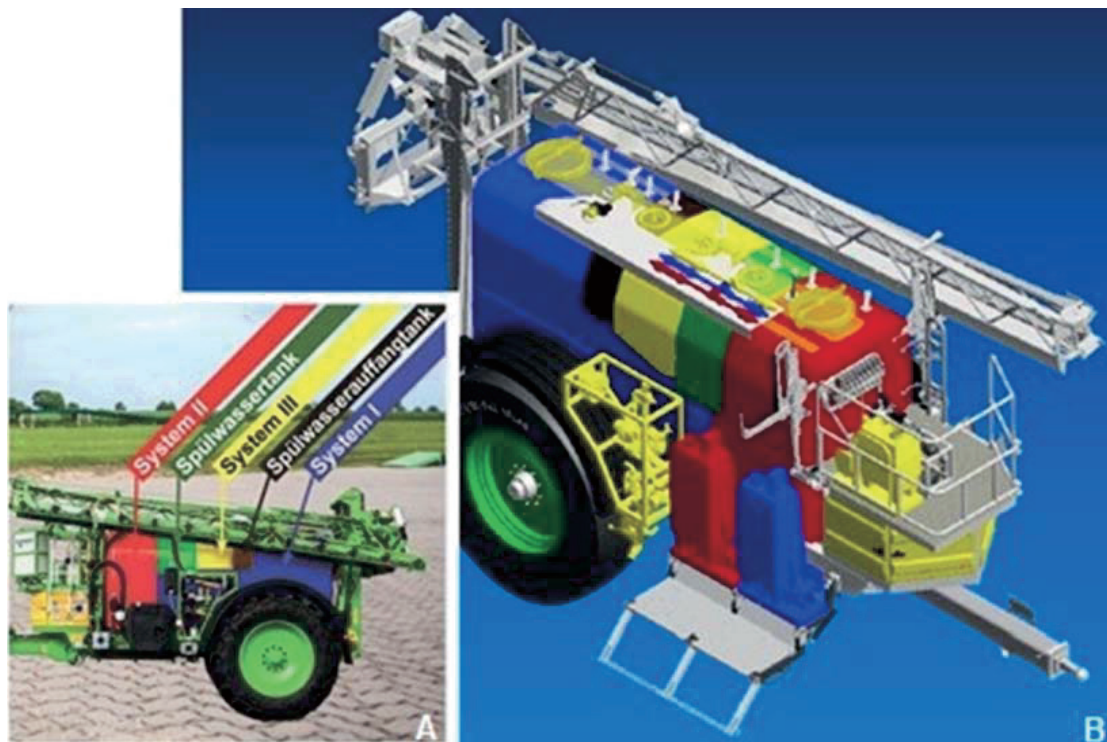
Abb. 1. Forschungsfeldspritzgerät mit Direkteinspeisung. A) Aufteilung des Forschungsfeldspritzgerätes mit Direkteinspeisung in die verbauten und unabhängig voneinander funktionierenden Systeme auf einem Fahrgestell mit farblicher Codierung (Blau – System I, Rot – System II, Gelb – System III, Grün – Spülwassertank, Schwarz – Spülwasserauffangtank). B) CAD-Zeichnung vom Forschungsfeldspritzgerät mit Direkteinspeisung. Die farbliche Codierung zeigt die Zugehörigkeit einzelner Komponenten zum jeweiligen System.
