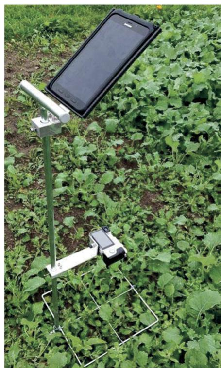
Abb. 2. Modifizierter Göttinger Zähl- und Schätzrahmen mit fest montierter Kamera zur Bilderfassung und einem Tablet zur Erfassung der GPS-Koordinaten und Unkraut-Boniturdaten.
