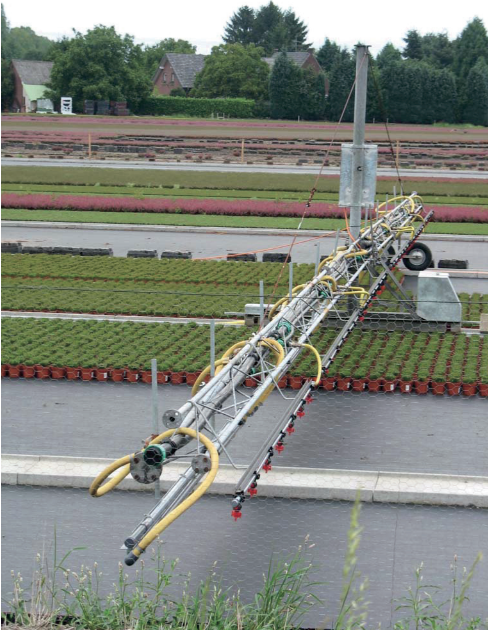
Abb. 5. Applikation von Pflanzenschutzmitteln mithilfe eines Gießwagens auf einer Containerstellfläche (Götte)
