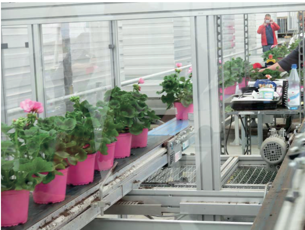
Abb. 10. Automatisierter Transport von Topfpflanzen im Gewächshaus mittels Transportband (Götte)
